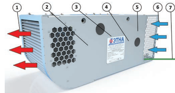
Функциональная схема адаптивного отопителя салона транспортного средства. 1 — нагретый воздух; 2 — блок нагрева; 3 — вентилятор; 4 — блок обработки информации и управления; 5 — цифровой датчик температуры; 6 — входящий воздух; 7 — поступающее по CAN-шине значение температуры окружающей среды.
