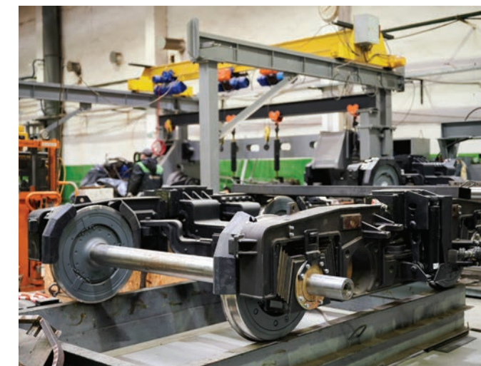
Низкопольная тележка на сборке в производственном цеху
