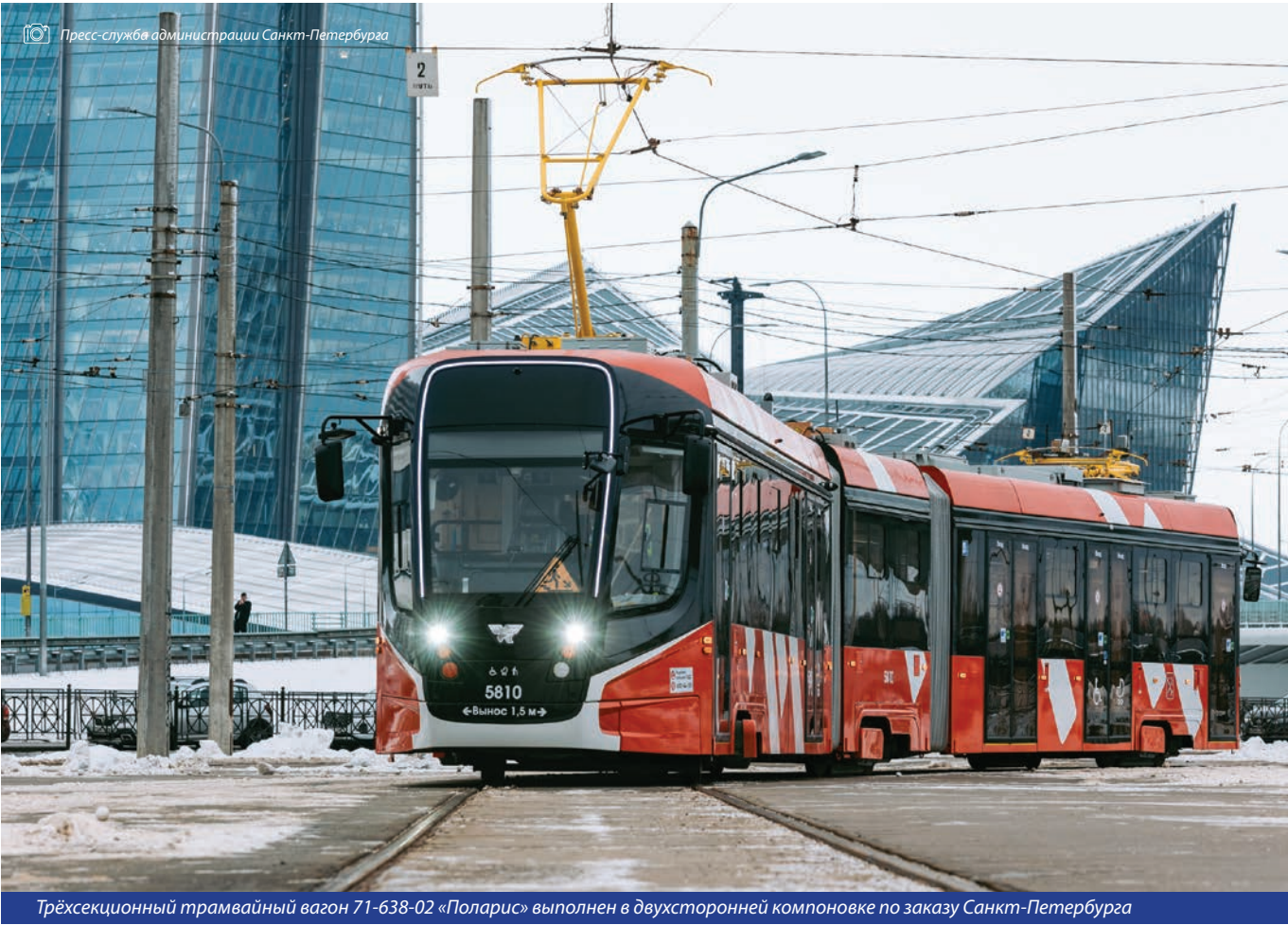
Трёхсекционный трамвайный вагон 71-638-02 «Поларис» выполнен в двухсторонней компоновке по заказу Санкт-Петербурга
